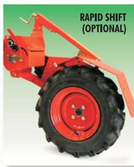
Ruote di trazione in gomma, dotate di Rapid Shift, sistema a cambio rapido.
